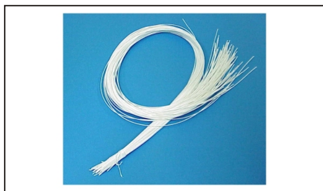
Figura 3 - Feixe de membranas microporosas de geometria cilíndrica do tipo fibra oca.
