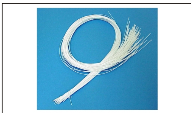
Figura 3 - Feixe de membranas microporosas de geometria cilíndrica do tipo fibra oca.
